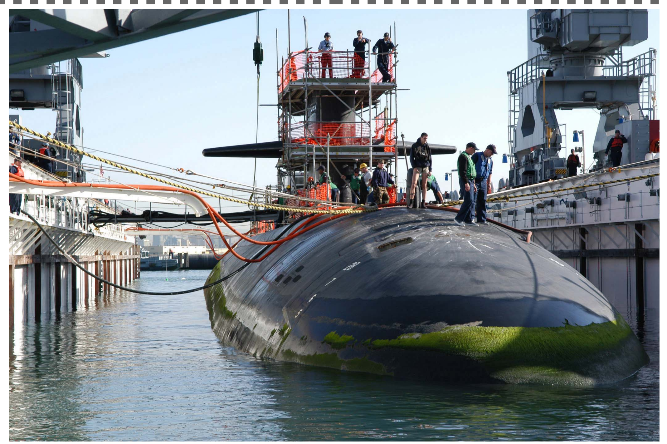
Gummibeläggning på atomubåt, 25-30 mm "Naval Yard", USA, Januari 2008
